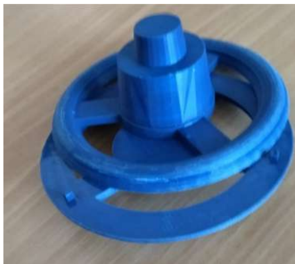
Рис. 3. Модель отливки, полученная при помощи 3D печати
