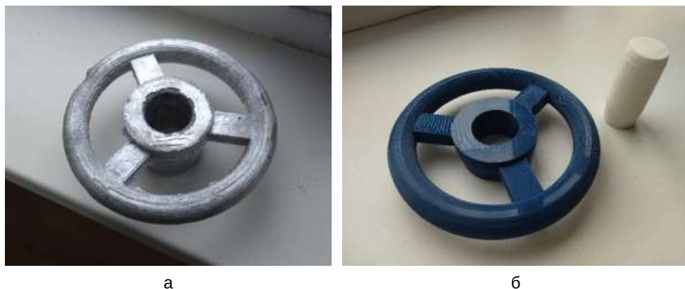
Рис. 7. Металлическая отливка из АК12, полученная литьём в песчано-глинистую форму (а); прототипы отливки детали и стержня, полученные при помощи 3D печати (б)
