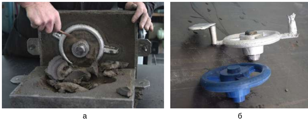
Рис. 6. Выбивка отливки из литейной формы (а), отливка с литниковой системой и стержнем (б)
