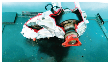
Рис. 2. Стенд-макет раздаточной коробки автомобиля БМВ (система полного привода X-drive). Разработчики: Д.Ю. Косенко, А.В. Музыка, В.А. Сафонов, А.А. Шикалов, студенты колледжа
