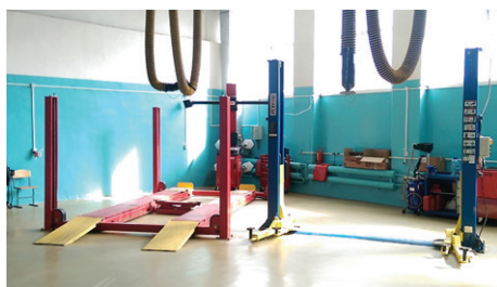
Рис. 5. Учебная станция технического обслуживания автомобильного транспорта: пост выполнения работ по установке углов колес автомобиля с современным 3D стендом Hanter (слева красный подъемник) и пост по техническому обслуживанию автомобилей с двухстоечным подъемником (справа синий подъемник)
